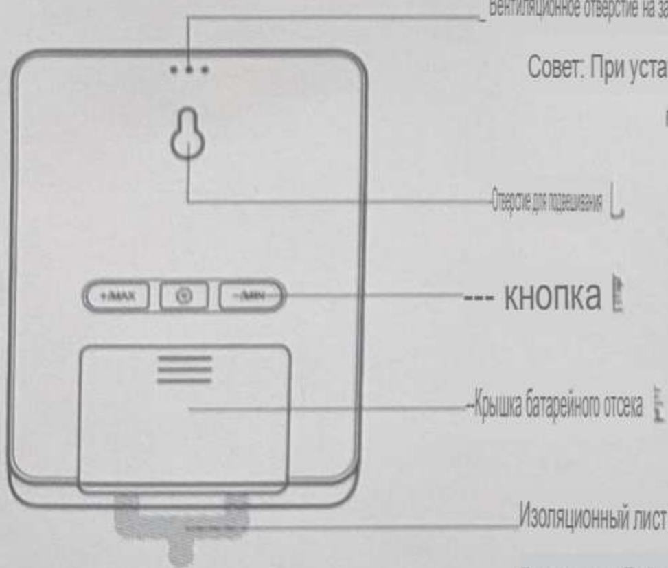
Вентиляционное отверстие на задней панели
